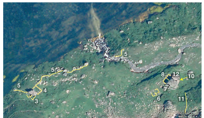
Abb. 4: Grindelwald, Zäsenberg. Im Gelände erkennbare Siedlungs- und Alpwirtschaftsspuren. Weidemauern 1, 5, 9 und 11; Gebäudegrundrisse 3, 4, 6 und 8; Felsunterstand 10; Kühlkeller unter Felsblöcken 2 und 7; heutige Schäferhütte 12. M. 1:10000 links und M. 1:2000 rechts.
